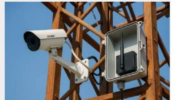
Kamera und geöffnete Databox mit Transmitter am Kran befestigt.
